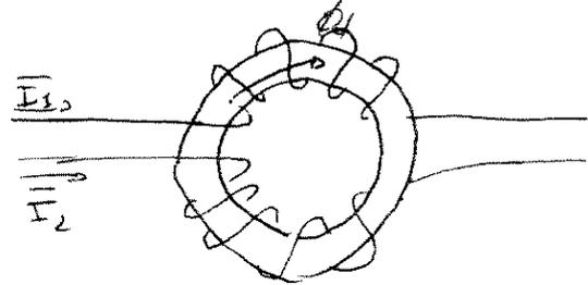
$$\begin{cases} E_1 = j\omega (M I_1 + M I_2) \\ E_2 = j\omega (M I_2 + M I_1) \end{cases}$$
