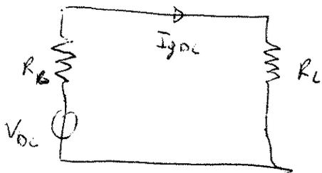
$$\begin{cases} I_{gDC} = \frac{V_g}{R_g + R_L} \\ V_{gDC} = V_g \frac{R_L}{R_g + R_L} \end{cases}$$
